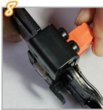
8. 將水晶頭放進工具鉗，對應卡洞，鉗壓金片
