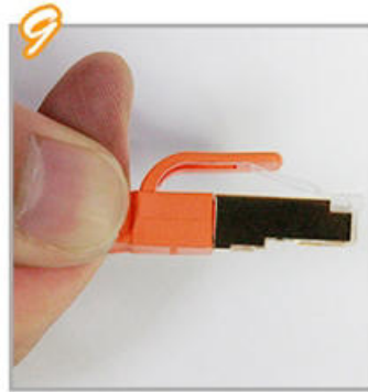
9. 將護套套進水晶頭，並將大壓板放在彈片上，完成
