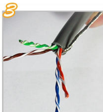
3. 把編織網捲成一股，剝開屏蔽鋁箔，露出內部線芯
